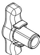
Конформатор применяется для выравнивания формы трубы перед выполнением соединения
