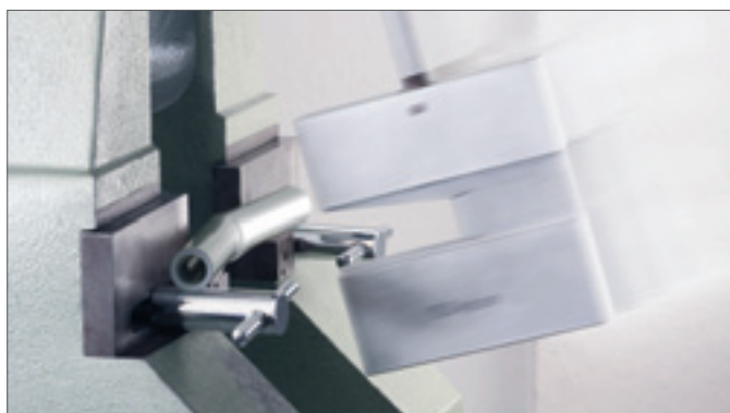
Рис. 4-6 Универсальная труба RAUTITAN flex в установке по испытанию ударной вязкости
