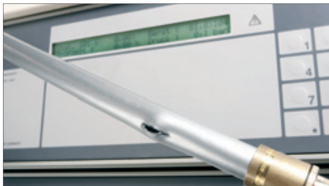
Рис. 4-5 Результаты испытания прочности на разрыв давлением. Испытуемый продукт – универсальная труба RAUTITAN flex
