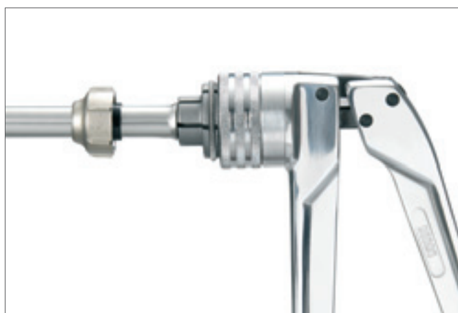
Рис. 15-7 Произвести развальцовку соединительной трубки
