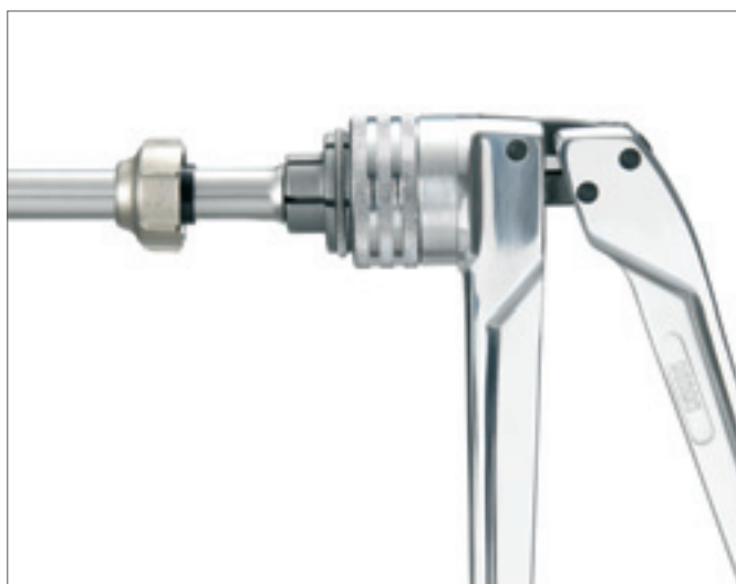
Рис. 15-3 Произвести развальцовку концевого участка трубки
