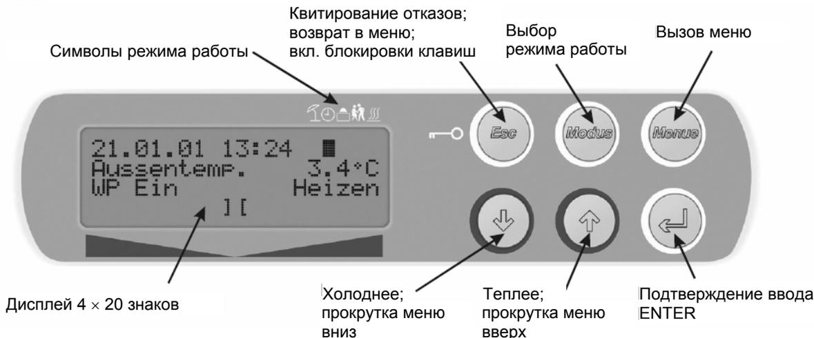
Рис. 7.1.a Вид регулятора теплового насоса
