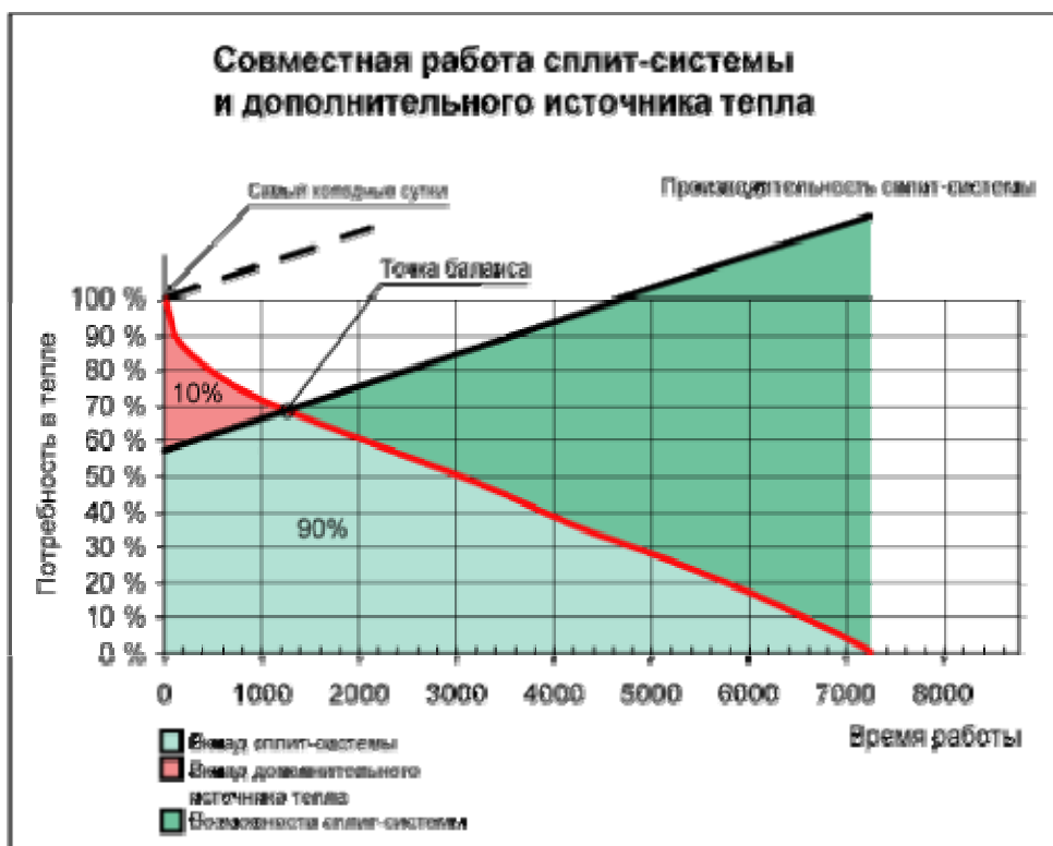
Рис. 5 Совместная работа сплит-системы и дополнительного источника тепла
