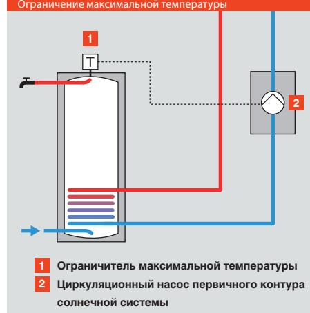
Во избежание парообразования в системе горячего водоснабжения, в верхней части водонагревателя устанавливают ограничитель максимальной температуры, который при превышении значения 95 °C прекращает подачу электропитания на циркуляционный насос первичного контура.
