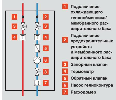
Кроме насоса гелиоконтура, в насосный узел Solar-Divicon входят все компоненты, необходимые для работы первичного контура.
