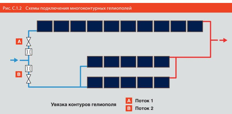
Для увязки контуров гелиополя разного размера и обеспечения надежной циркуляции применяются балансировочные клапаны.
