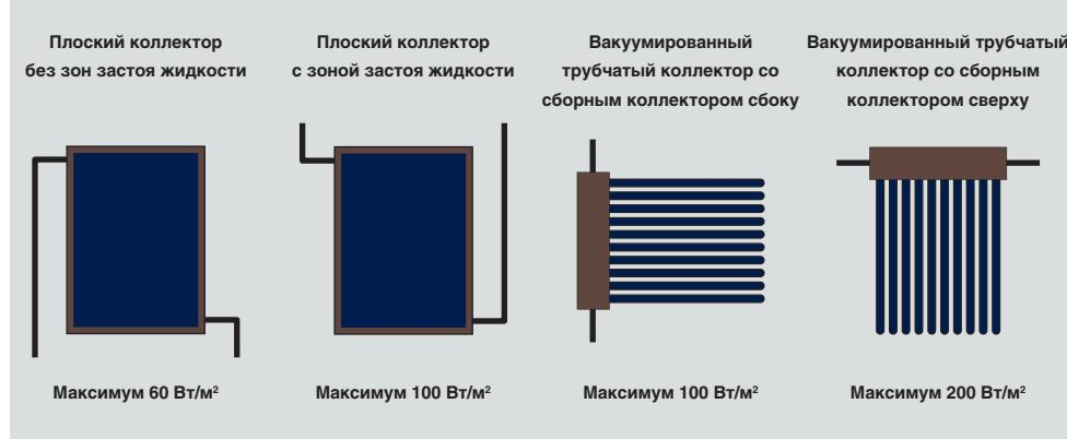
В зависимости от типа коллектора и гидравлического соединения принимаются разные значения мощности парообразования.
