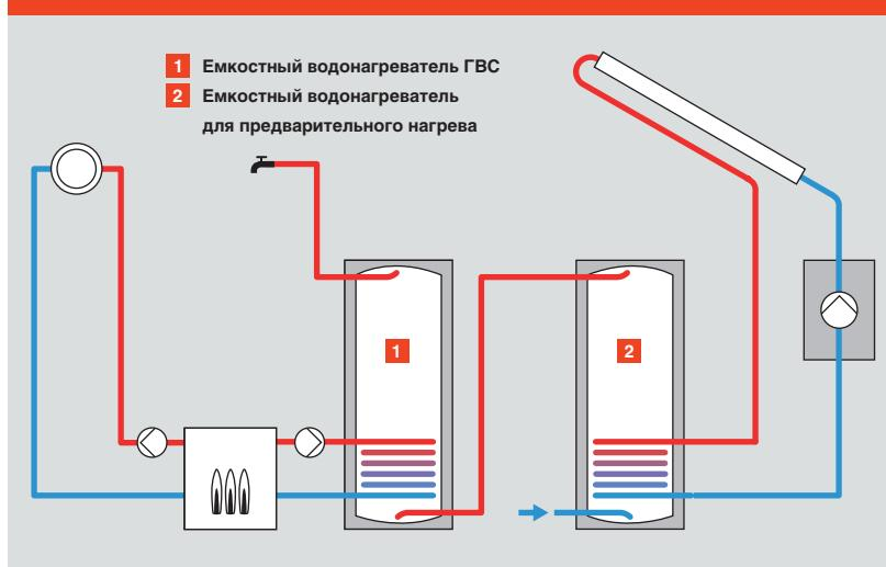
При модернизации системы ГВС емкостный водонагреватель солнечной системы может также работать как моновалентный водонагреватель для предварительного нагрева воды.
