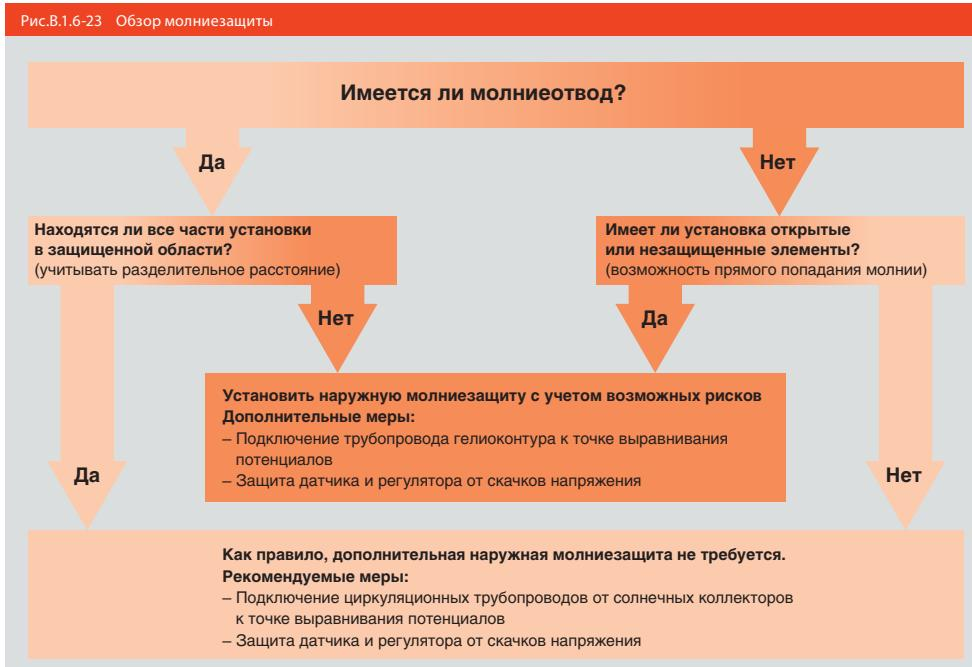
При монтаже коллекторов на крыше необходимо предусматривать их молниезащиту. Для установки или модернизации системы молниезащиты требуются соответствующие специалисты.
