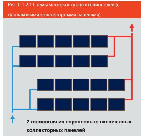
Если коллекторные панели многоконтурного гелиополя имеют одинаковые размеры, можно отказаться от балансировочного клапана в случае подключения трубопроводов по Тихельманну.
