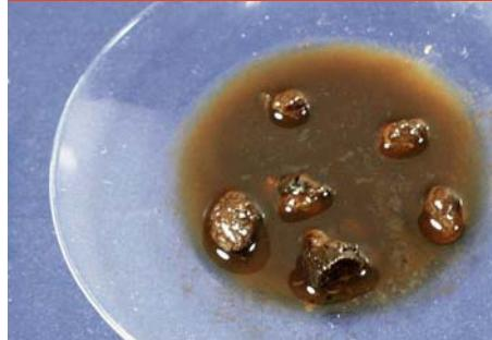
Под воздействием высоких температур и кислорода теплоноситель разрушается, в результате чего могут образовываться твердые отложения.
