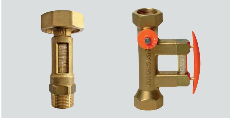
Расходомер, встроенный в трубопровод (слева), является составной частью Solar-Divicon. Модификация расходомера с байпасом используется при гидравлической увязке частей системы с несколькими гелиополями.
