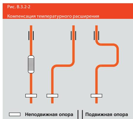
Рис. В.3.2-2 Повреждение вследствие температурного расширения.
