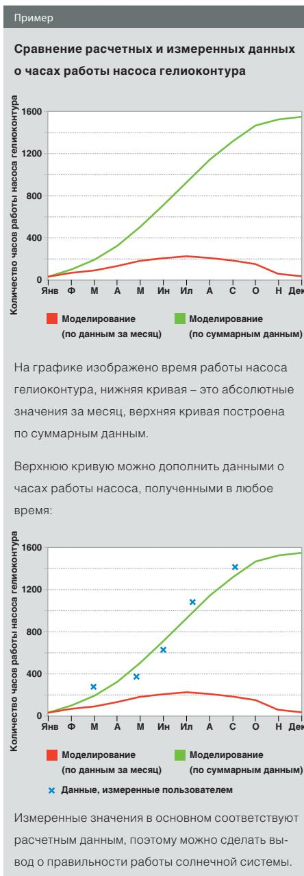
Точно так же можно поступать и с данными оценки или измерения количества теплоты. При этом важно объяснить пользователю, что в расчет принимаются не абсолютные значения, а усредненные с учетом погрешности.
