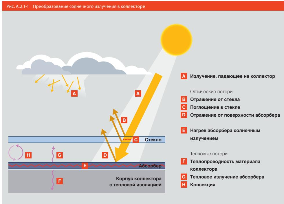
Излучение, падающее на коллектор, уменьшается на величину оптических потерь. Оставшаяся часть излучения нагревает абсорбер. Количество теплоты, отдаваемое коллектором в окружающую среду, является тепловыми потерями.
