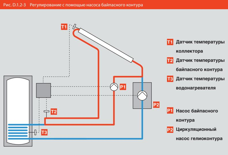
Регулирование с помощью насоса байпасного контура: P1 работает, когда T1 больше T3. P2 работает только тогда, когда T2 больше T3. (Соответственно, должна учитываться необходимая разность температур).
