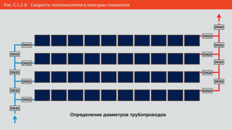
Для обеспечения необходимой скорости теплоносителя расчет диаметра соединительных трубопроводов выполняется по значению расчетного расхода теплоносителя в каждом контуре гелиополя.
