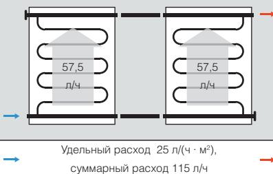
Если коллекторы включены последовательно, расход теплоносителя через коллектор составляет примерно  $2 \text{ л}/\text{мин}$  ( $115 \text{ л}/\text{ч}$ ). Потери давления в одном коллекторе составляют около 200 мбар. Потери давления суммируются, таким образом, суммарные потери давления в гелиополе составляют около 400 мбар.
