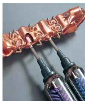
Рис. B.1.2-5 Соединение конденса́тора теплово́й трубы с циркуляцио́нным конту́ром относи́тся к так называе́мому «сухому» типу.
