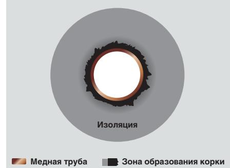
Допускается образование небольшой корки на внутренней стороне теплоизоляционной оболочки с закрытыми ячейками.
