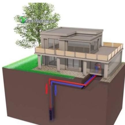
Одна и та же скважина, может быть как эксплуатационной, так и нагнетательной. В нижнюю часть скважины помещается насос, посредством которого вода из скважины подается к испарителю теплового насоса. Обратная вода возвращается в верхнюю часть водяного столба в ту же скважину (рис. 2.9). Обычно скважины такого типа используются и для снабжения здания питьевой водой.
