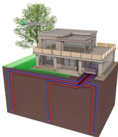
Контур размещается вертикально в пробуренную вертикальную скважину, или несколько таких скважин (рис. 2.3). Глубина скважин и погонные метры контура, зависит от объёма обогреваемой площади и состава грунта. Этот способ применяется в случаях, когда площадь земельного участка не позволяет уложить контур горизонтально или угроза повреждения ландшафта.
