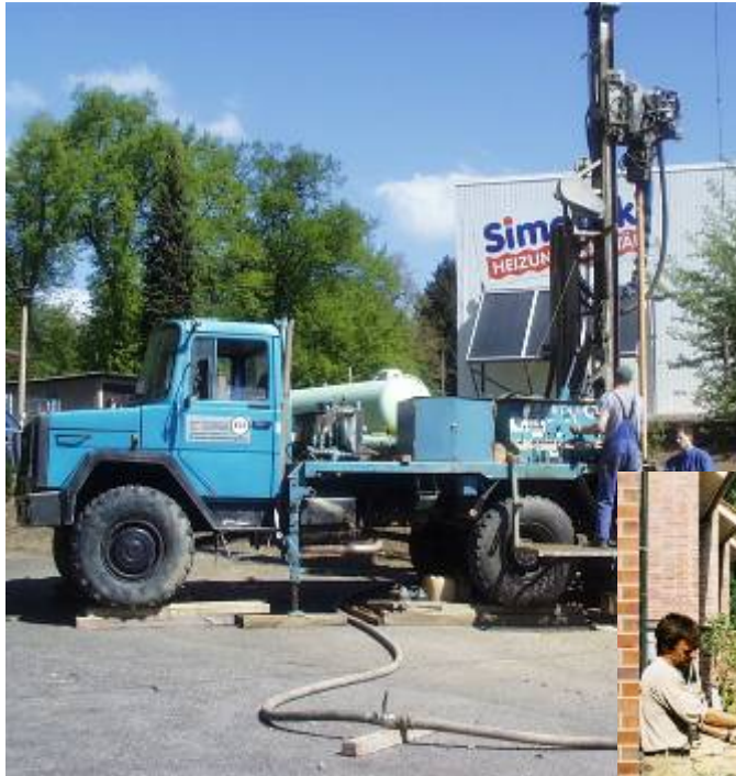
Бурильный станок на автомашине Unimog
